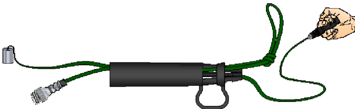
10. sz. ábra. Csatlakoztatás duplán átvezetett jelvezetékkel
