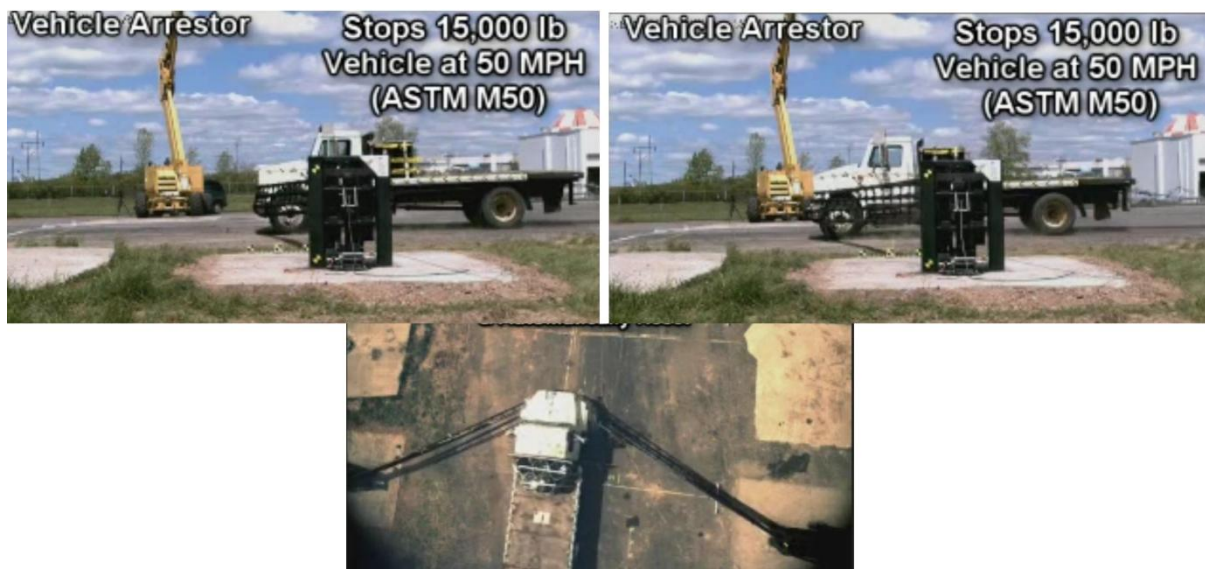
22. kép Háló megnyúlása a védett terület csökkenését eredményezi 22
