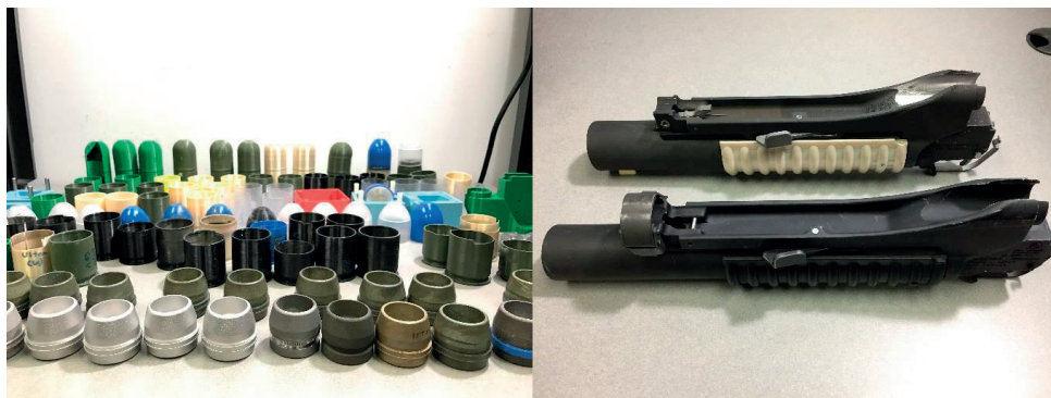
3. ábra. 3D-nyomtatott löszerek (bal) és egy 3D-nyomtatott és az eredeti alkatrész összehasonlító képe látható
