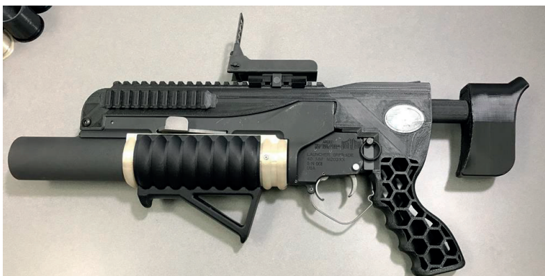
2. ábra. Az első ARDEC által készített 3D-nyomtatott gránátvető, amelyből 3D-nyomtatott löszert sütöttek el
